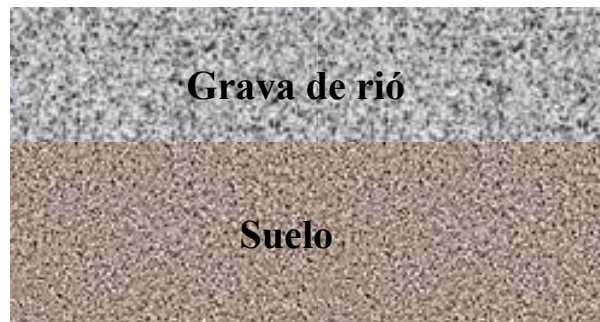
Figura 8 Estructura de pavimento típica Calles en lastre Ciudad de Upala
