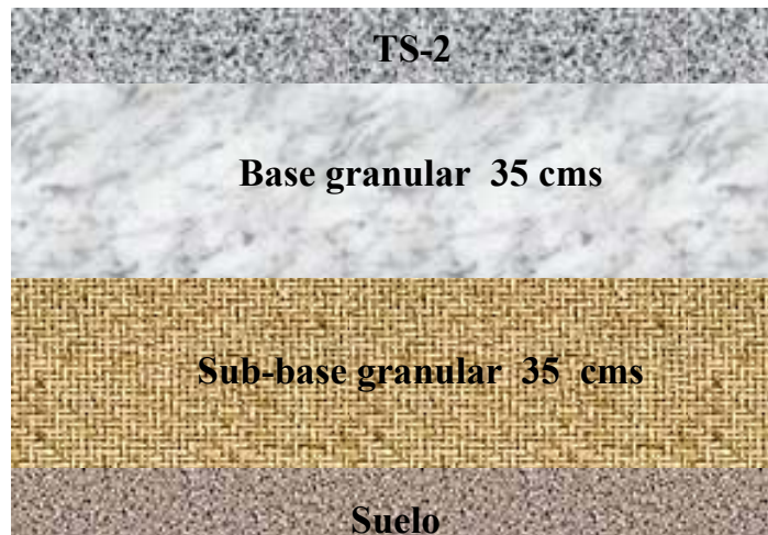
Figura 10 Refuerzo de estructura de de pavimento Calles con TS Ciudad de Upala
