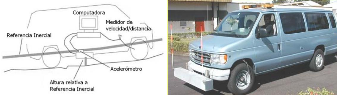
Figura 12. Perfilómetro Inercial Láser (Fuente: LanammeUCR, 2008).
