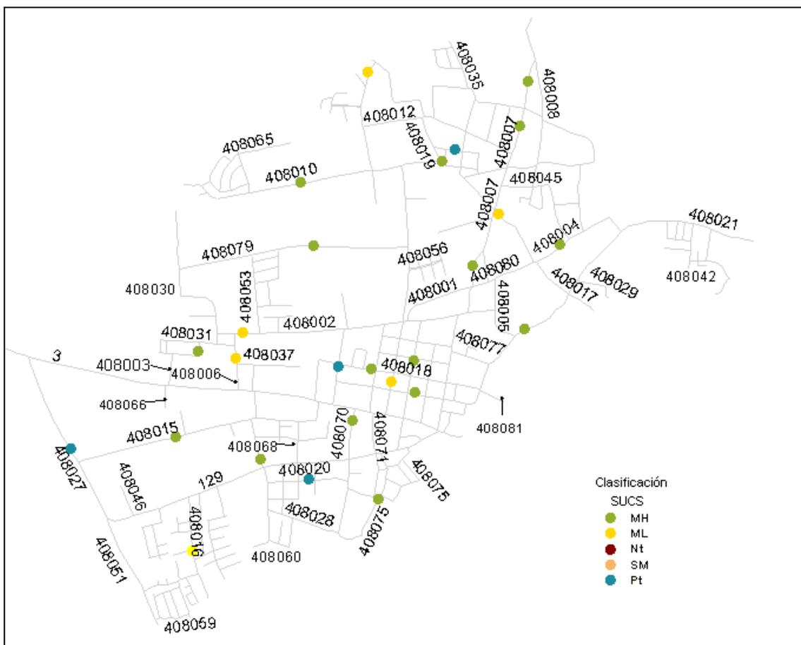
Figura 19. Resultados de tipo de suelo para la sub-rasante en la RVC de Flores (Fuente: LanammeUCR, 2009).
