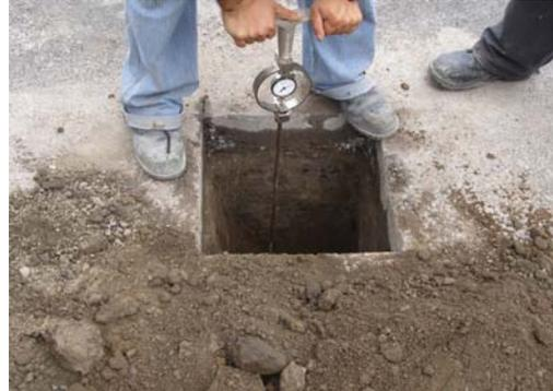
Figura 20. Prueba de CBR en sitio (Fuente: LanammeUCR, 2008).
