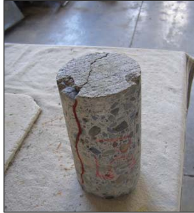
Figura 5.1: Núcleo de concreto utilizado para determinar la profundidad de grieta
