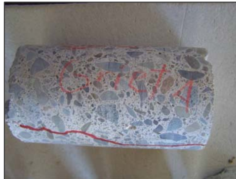
Figura 5.2: Núcleo de concreto utilizado para determinar la profundidad de grieta
