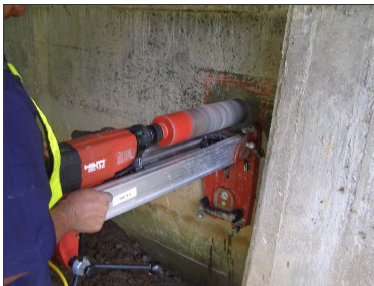
Figura 2.2: Extracción de núcleo de la pantalla del bastión izquierdo (hacia Quepos)
