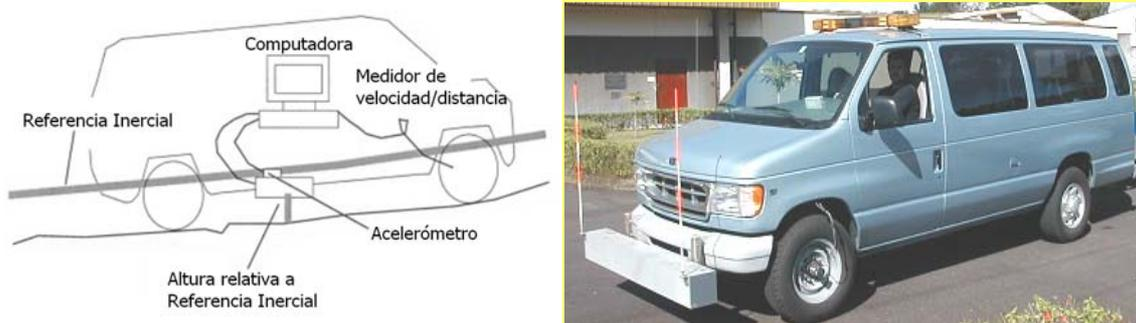
Figura 14. Perfilómetro Inercial Láser (Fuente: LanammeUCR, 2008).
