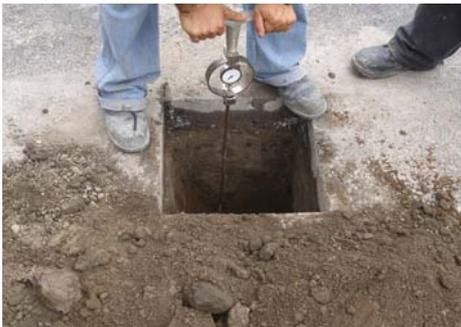
Figura 24. Prueba de CBR en sitio (Fuente: LanammeUCR, 2008).
