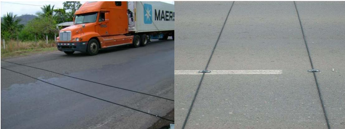
Figura 3. Cables y contadores automáticos en sitio. (Fuente: LanammeUCR, 2008).
