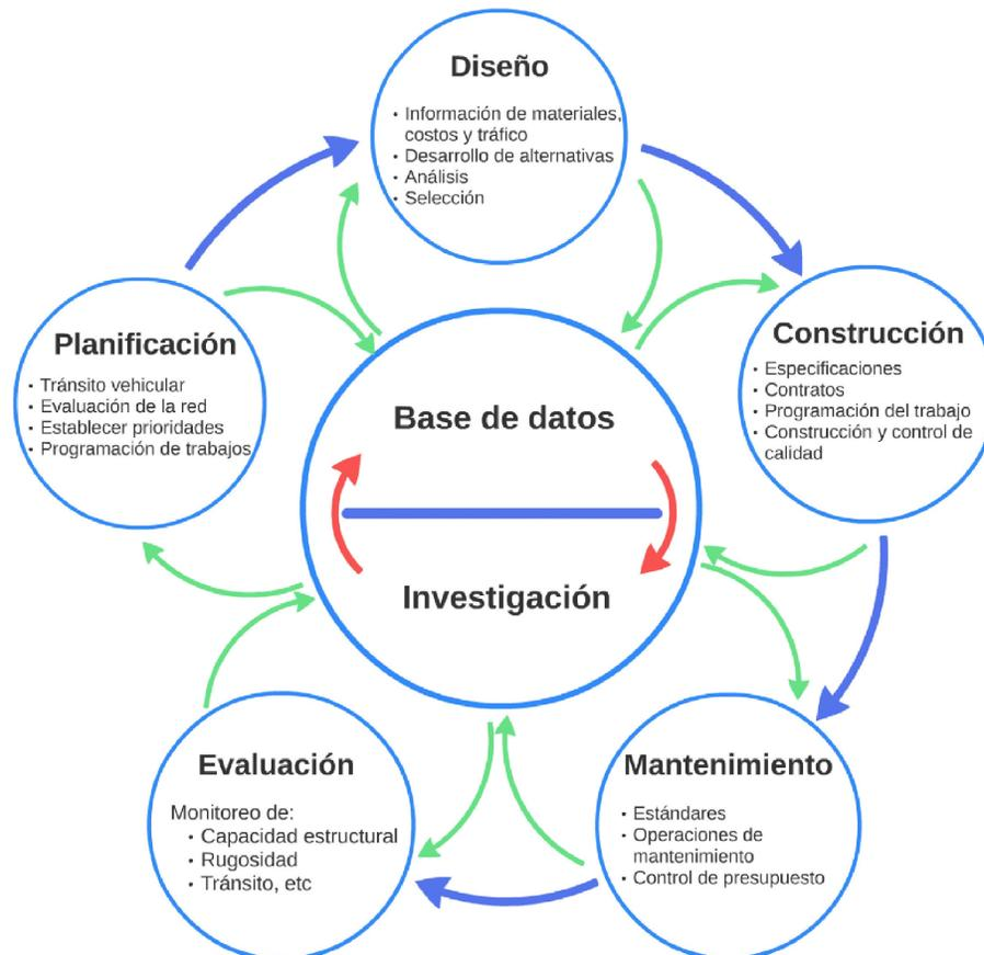
**Figura 1.** Estructura general de un sistema de gestión de pavimentos.
