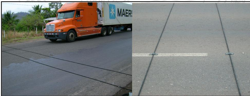
**Figura 4.** Cables y contadores automáticos en sitio.
