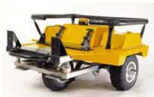
**Fotografía No. 4:** Equipo Grip Tester utilizado por la Unidad de Laboratorio del LanammeUCR para la medición del Grip Number que determina la fricción entre llanta y pavimento.
