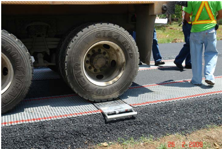
Fotografía 7. Sistema de pesaje móvil utilizado por el LanammeUCR.
