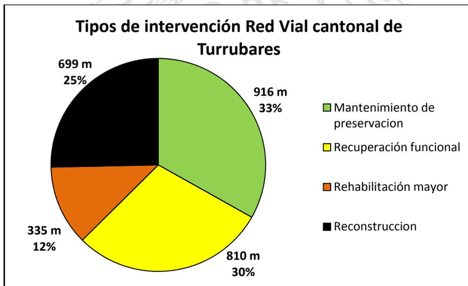
**Figura 32.** Tipos de intervención requerida para la red vial cantonal de Turrubares.
