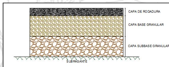
**Figura 16.** Ejemplo de estructura de pavimento.
