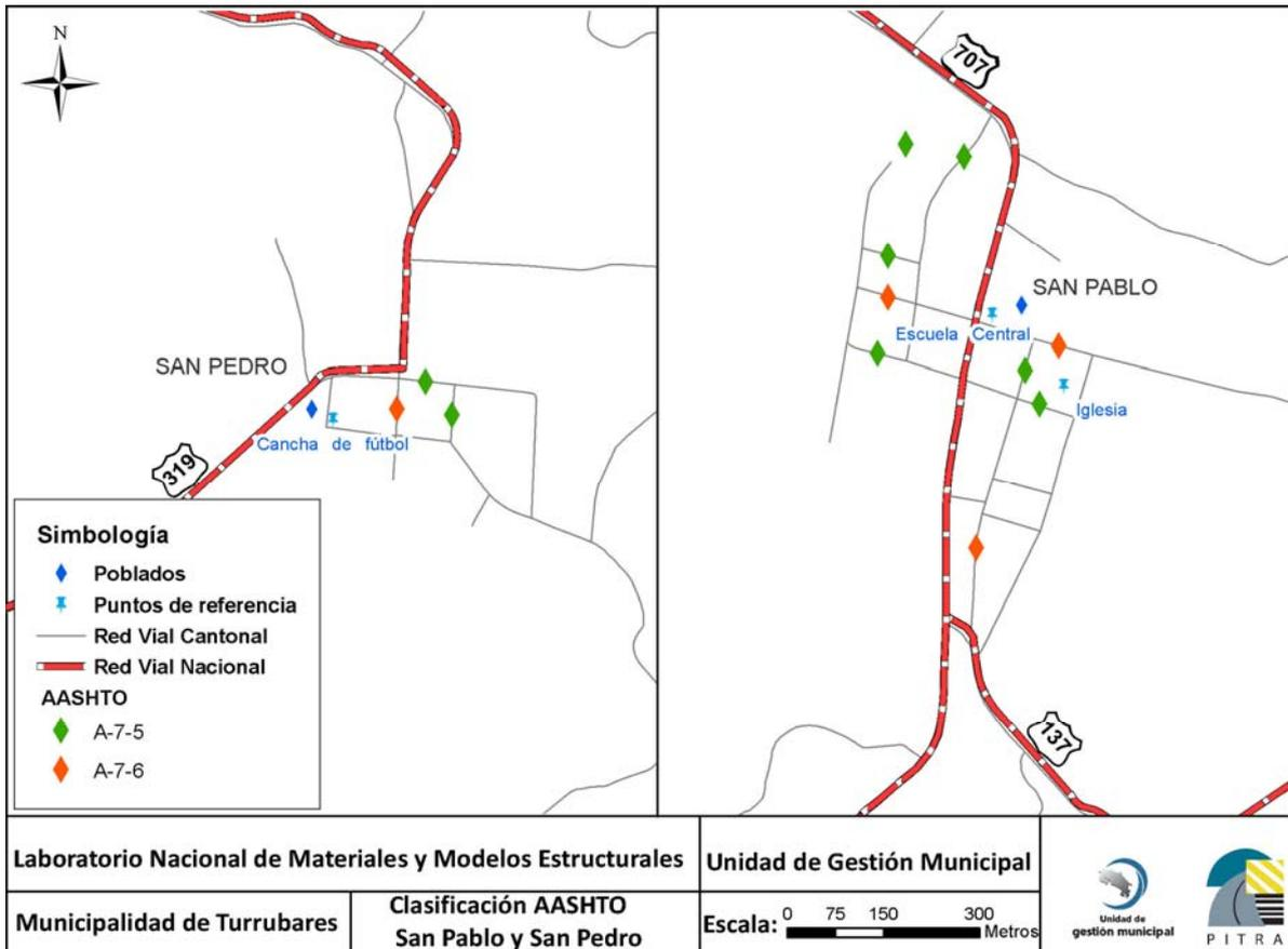
**Figura 19.** Caracterización de la sub-rasante según AASHTO.
