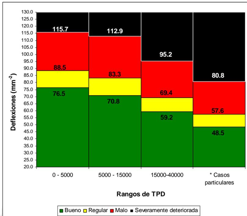
**Figura 13.** Condición del pavimento a partir de deflectometría y TPD, para una estructura con base granular.
