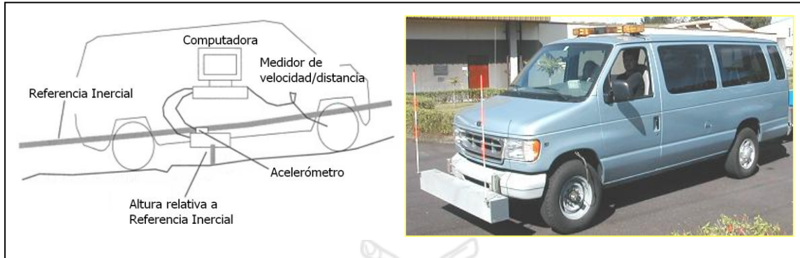
Figura 9. Perfilómetro Inercial Láser.
