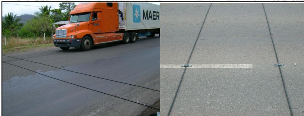
Figura 4. Cables y contadores automáticos en sitio.
