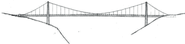
A) Puente colgante de acero
