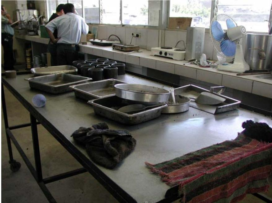
**Fotografía 12: Mesa utilizada para el proceso de cuarteo**
