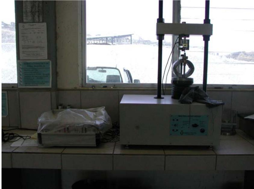
**Fotografía 17: Equipo para la determinación de la estabilidad y el flujo**
