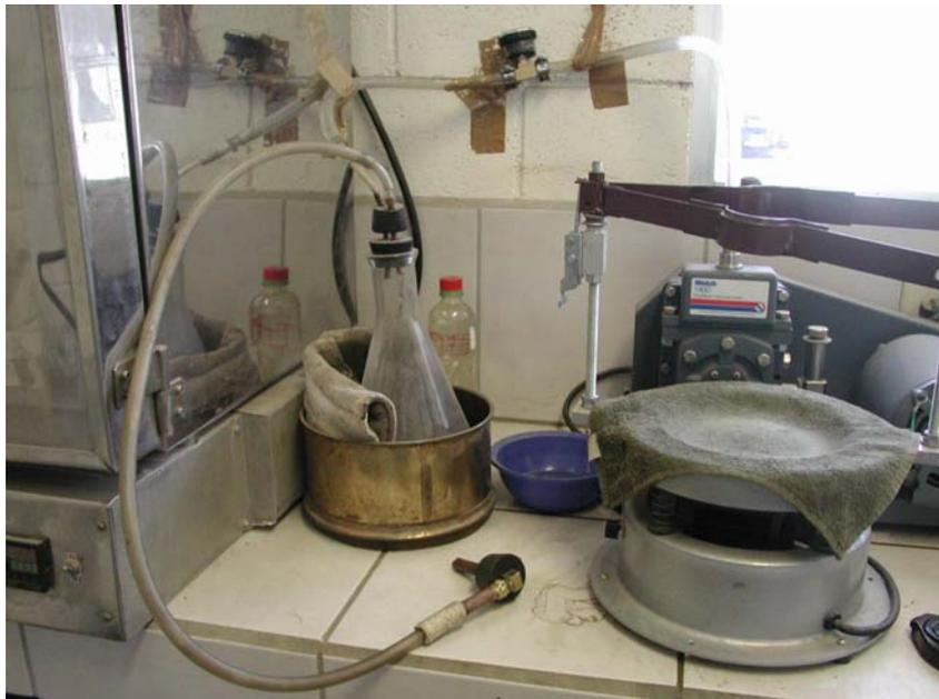
**Fotografía 15: Equipo utilizado para la determinación de gravedad específica máxima teórica**
