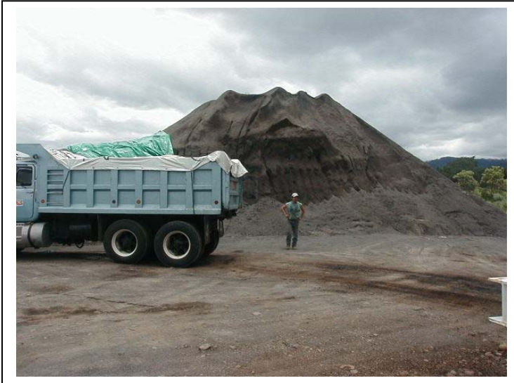
Fotografía No.12 Los apilamientos están contruidos deficientemente, tanto en forma como en altura.
