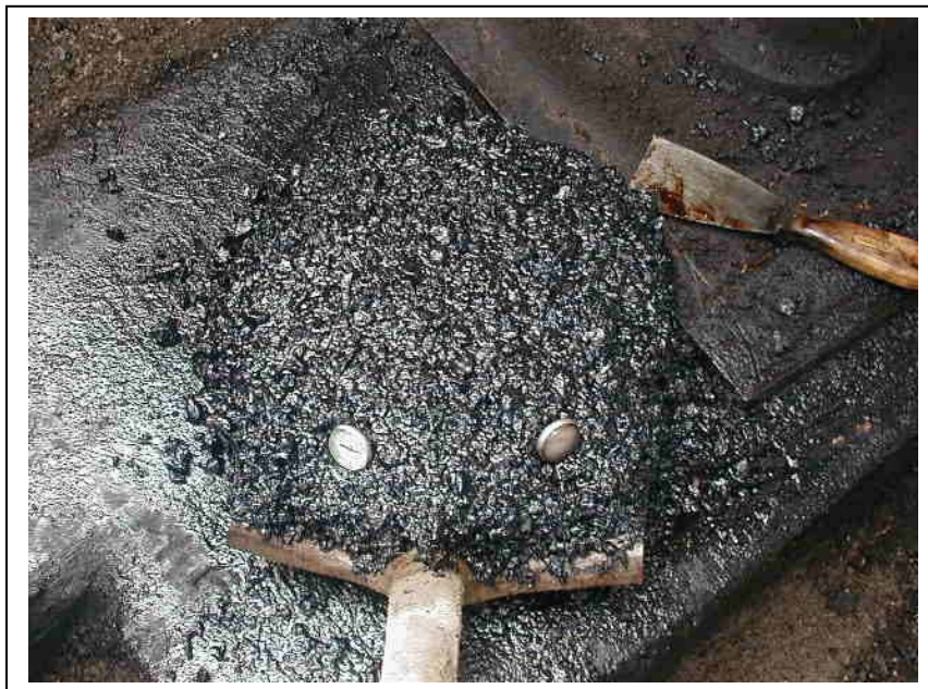
Fotografía No.14: Muestra de mezcla inestable, desplazamiento excesivo y burbujeo.
