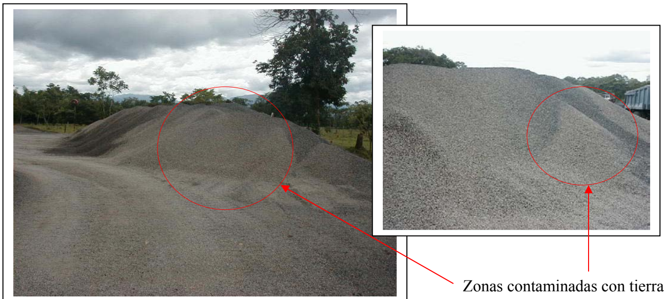
Fotografía No.11 : La manipulación de agregados que realiza el cargador contamina de polvo y tierra gran parte de los apilamientos.
