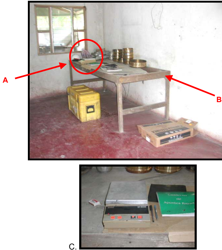
Fotografía 2: Vista interna de las Instalaciones del laboratorio de autocontrol de calidad en el proyecto, ubicadas en Olivia de Bribrí, Talamanca, durante la visita del 12 de agosto de 2003. (A) Ubicación de la balanza (B) Mesa de trabajo instalada para atender todas las labores de ensayo, obsérvese el detalle de la instalación eléctrica (C) Vista de frente de la balanza
