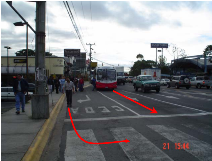
Fotografía 12: Parada de autobús ubicada en una zona inmediatamente anterior al paso peatonal existente.
