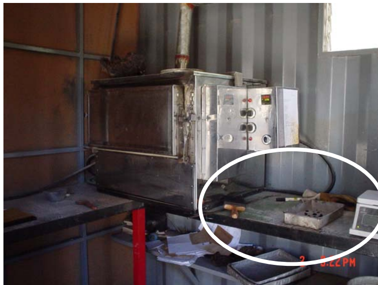
Fotografía 16: Horno de incineración del laboratorio. Obsérvese la distancia entre la balanza y el horno
