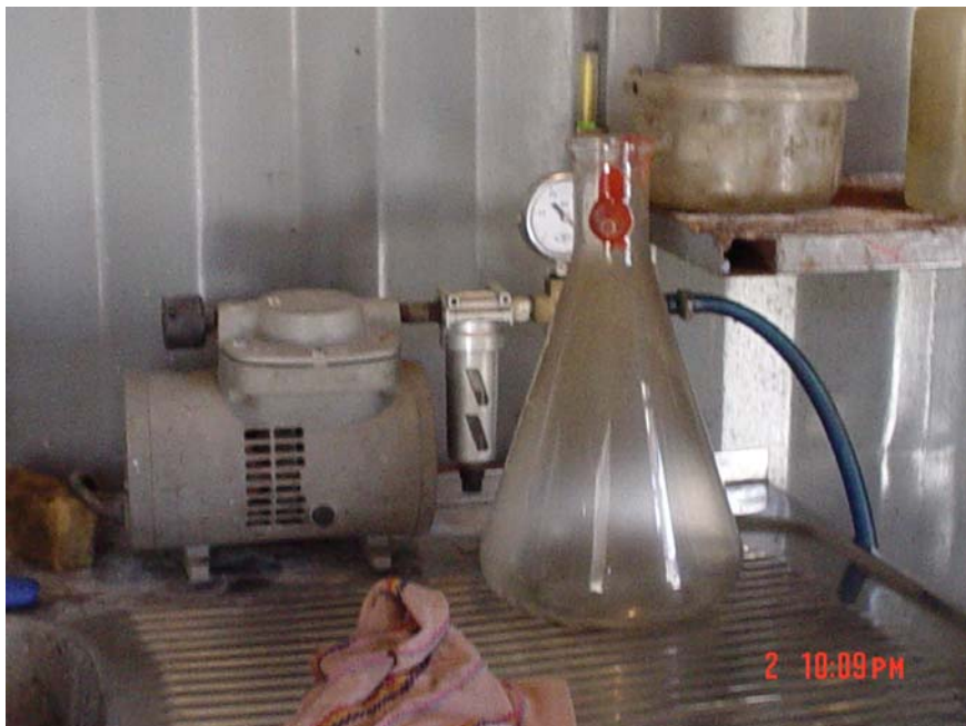
Fotografía 14: Equipo utilizado para la determinación de gravedad específica máxima teórica
