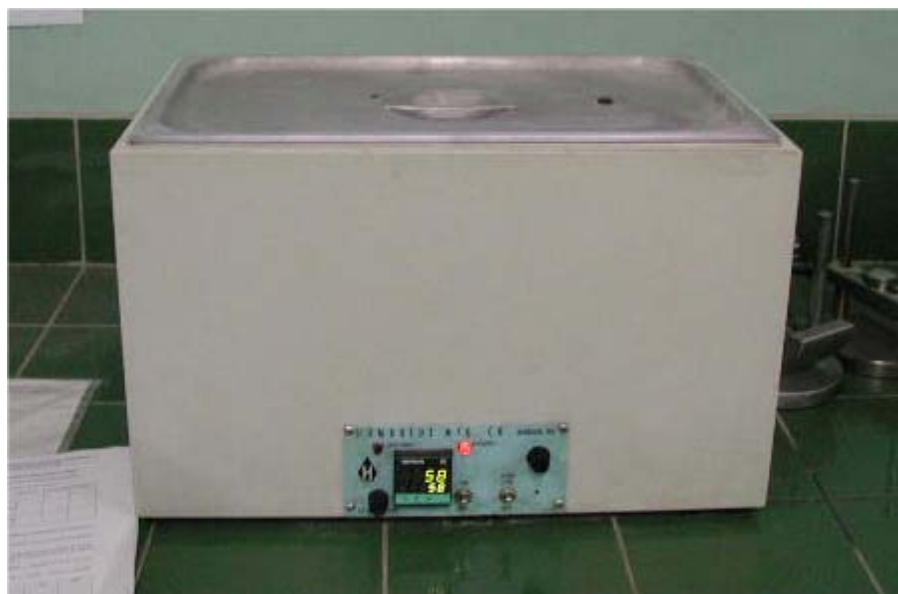
Fotografía 10: Baño para acondicionamiento de objetos de ensayo
