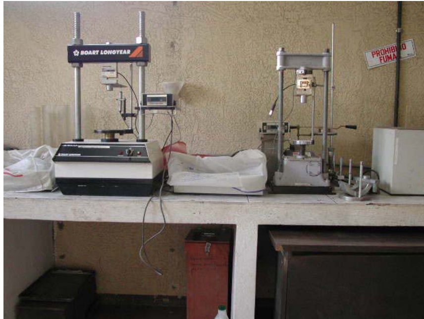
Fotografía 5: Equipos para la determinación de la estabilidad y flujo
