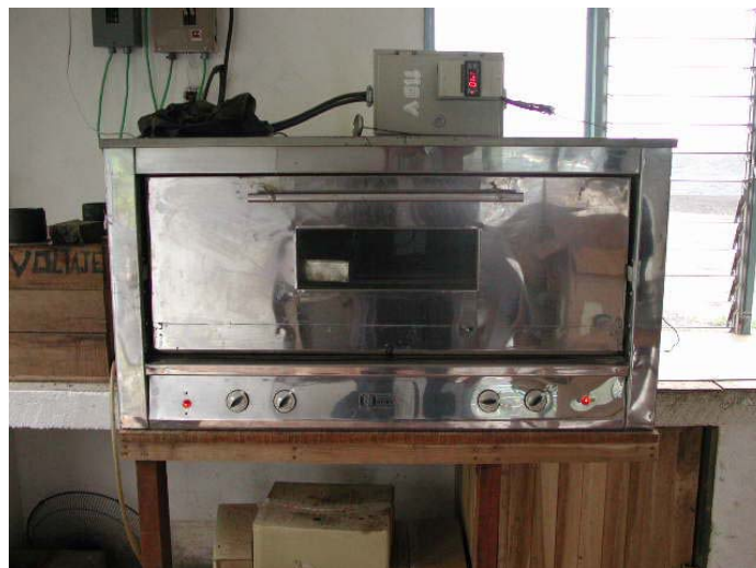
Fotografía 14: Horno de calentamiento de muestras
