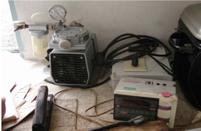
Fotografía 11: Bomba de vacío
