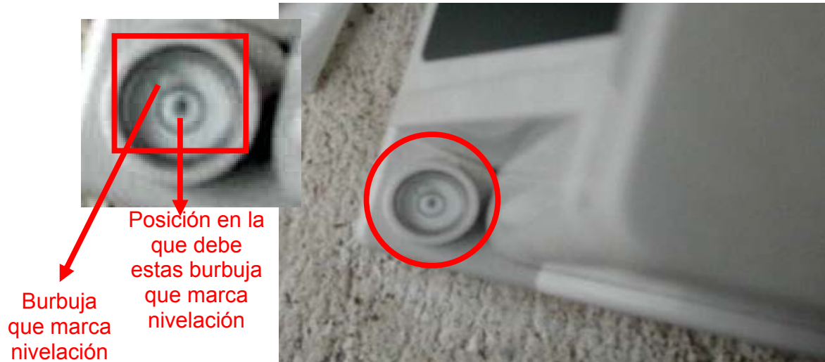
Fotografía 3: Detalle de medida de nivel de la balanza, donde se ve dentro del círculo que no se encuentra nivelada
