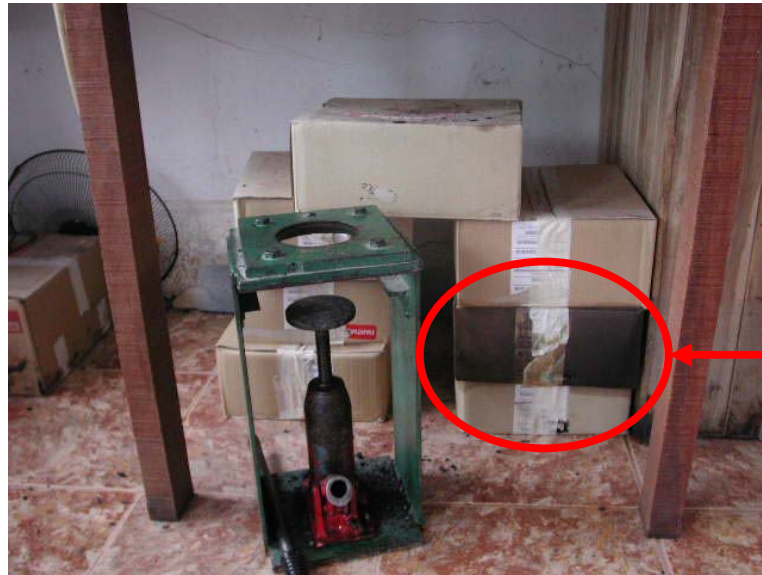
Fotografía 7: Almacenamiento de muestras a nivel de piso sin protección
