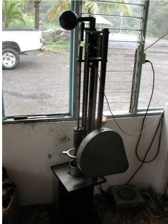
Fotografía 13: Instalación del Mazo Marshall
