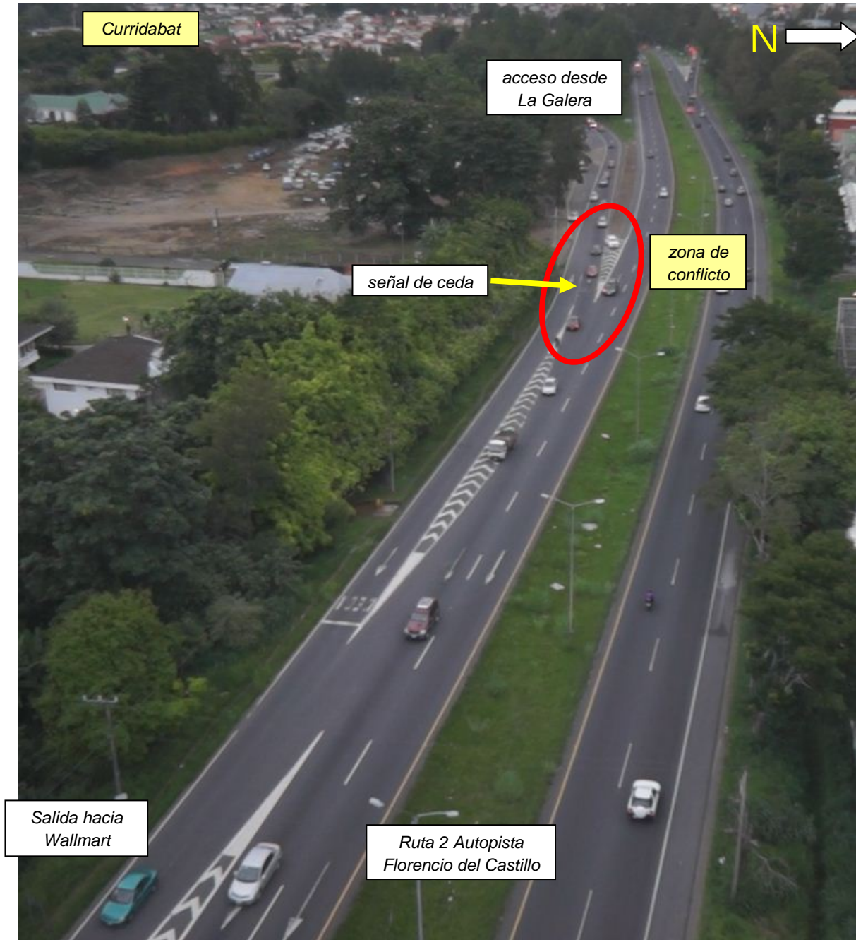
Figura 14: Comportamiento de conductores, intercambio en la Autopista Florencio del Castillo, hora pico de la tarde.
