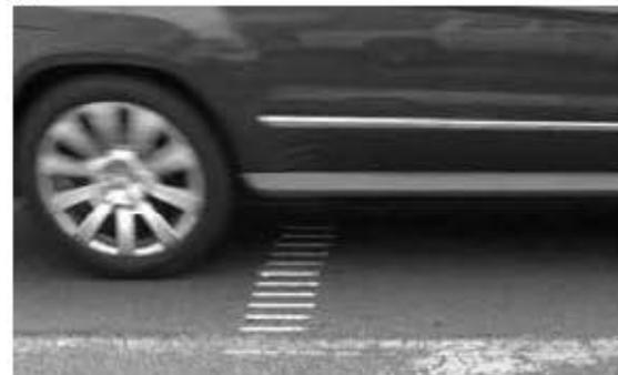
Figura 8. – Líneas demarcadas para medir la desviación lateral de la llanta, Ruta Nacional N°39.
