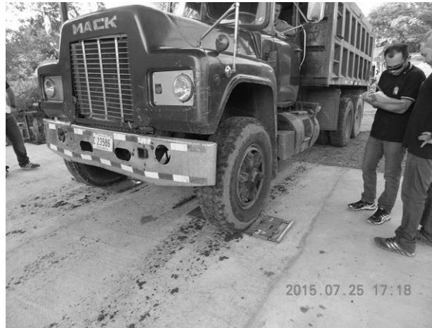
Figura 8.- Pesaje de los camiones
