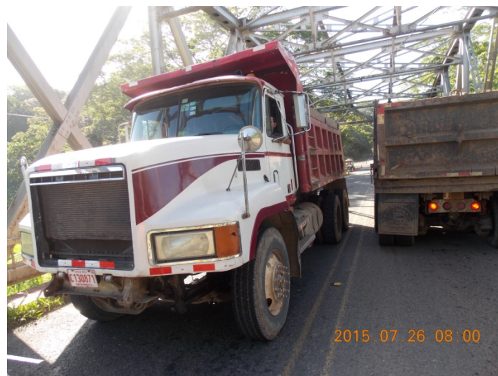
Figura 94. Ubicación de los camiones para producir máxima deformación vertical por flexión para el último nodo de medición (segundo nodo desde el apoyo y costado aguas abajo).
