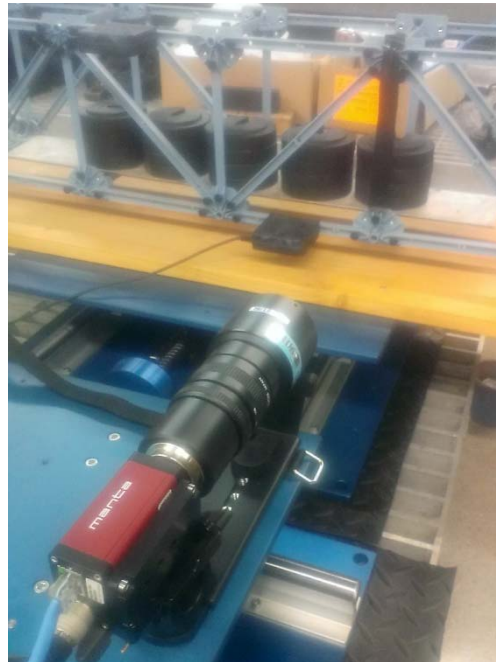
Figura 6. Lente de 18 mm a 108 mm de longitud focal utilizado en prueba de laboratorio.
