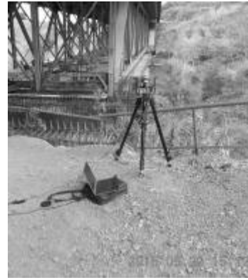
Figura 21.- Posición de la cámara respecto al puente sobre el río Virilla.
