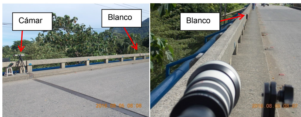
Figura 121. Posición de la cámara y trípode para el centro del tramo 3 (P2 en Figura 103).
