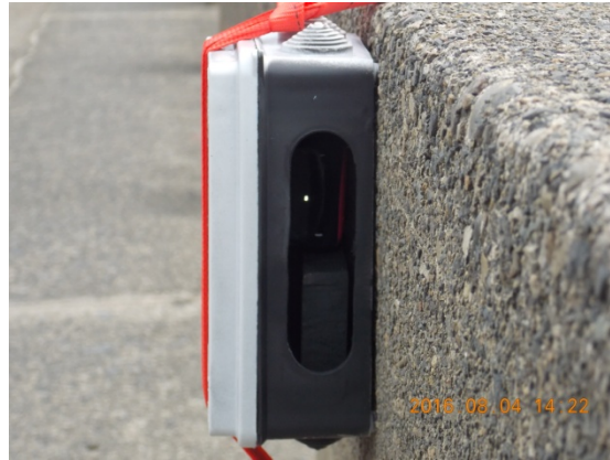
Figura 105. Blanco de rastreo fijado a la barrera vehicular
