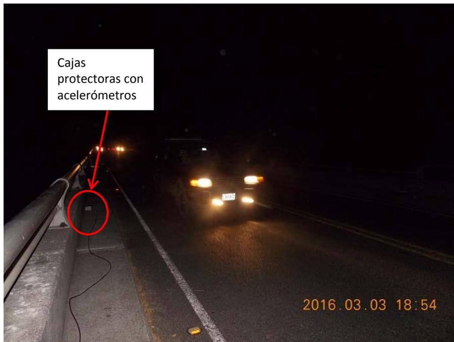
**Figura 12.** Vista de superestructura con equipos sobre los bordillos. Nótese que el monitoreo no interrumpe el tránsito de vehículos.
