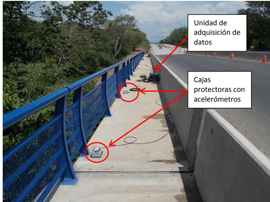
**Figura 10.** Colocación de sensores sobre las aceras del puente. El monitoreo no interrumpe el tránsito de vehículos.
