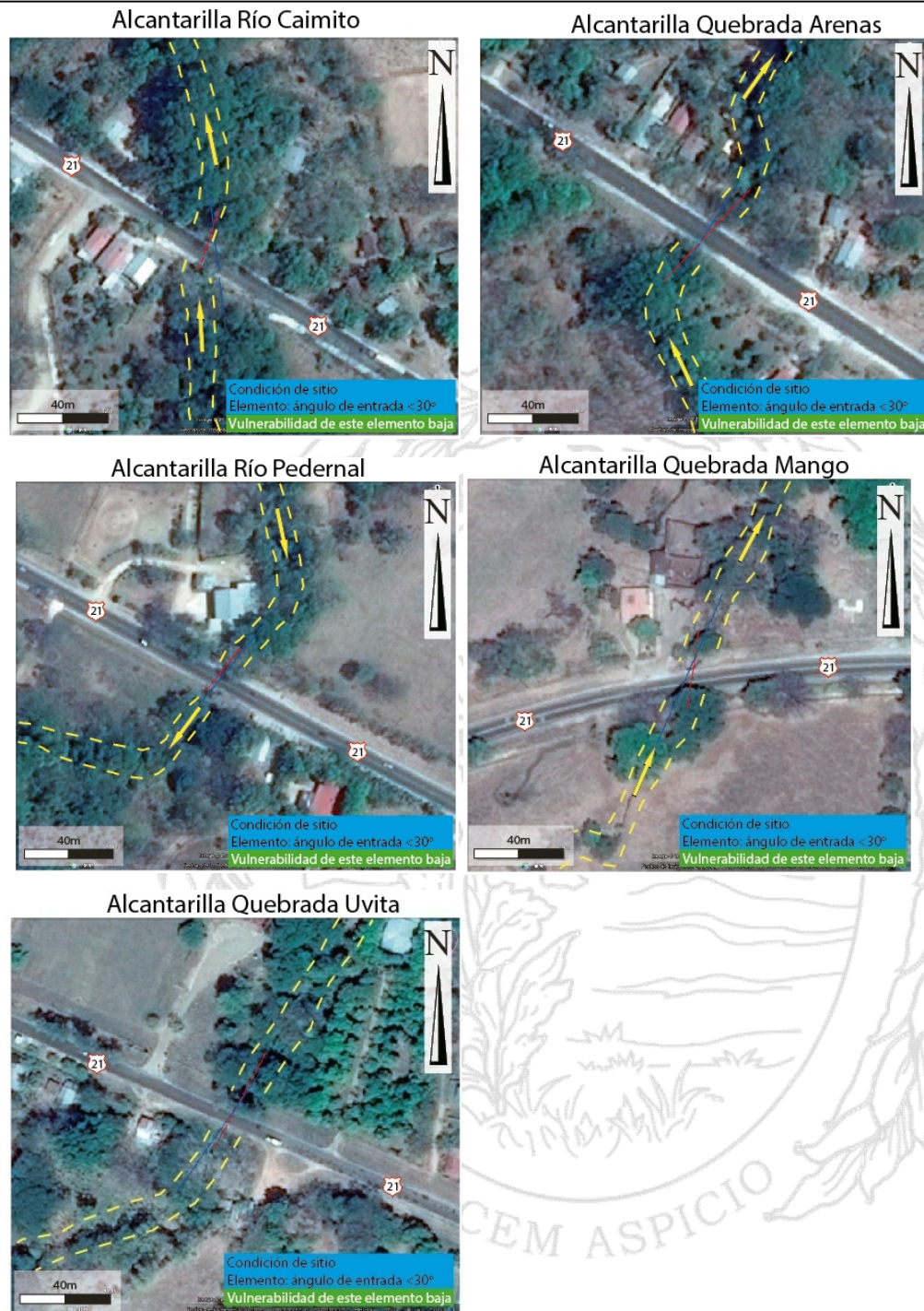
Figura No.3 Ángulo de entrada de las alcantarillas analizadas. Todas presentan ángulos de entrada < 30^\circ por lo que la vulnerabilidad por este concepto es baja.
