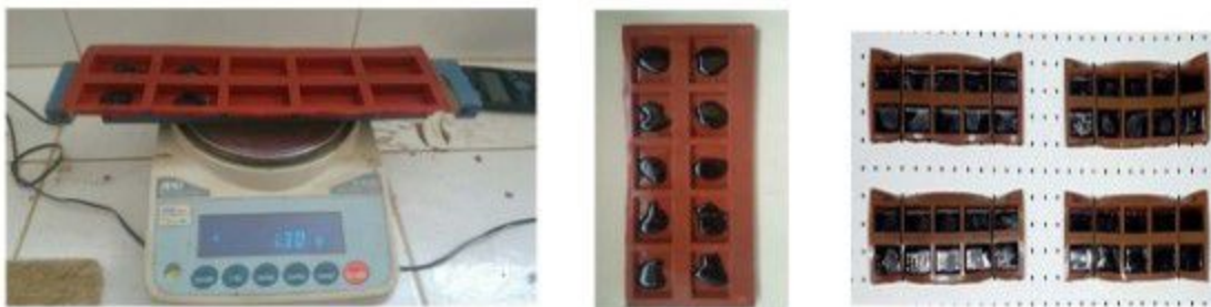
Figura 1 Preparación de muestras de asfalto para la oxidación a la intemperie
