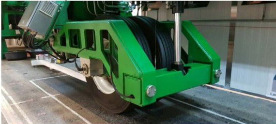
Figura 4. Ensayo con viga Benkelman y HVS
