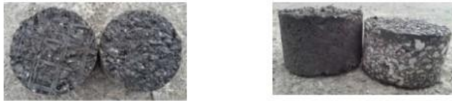
Figura 5 Espécimen hecho con geomalla después de ser ensayado con el dispositivo de corte directo en la máquina Marshall
