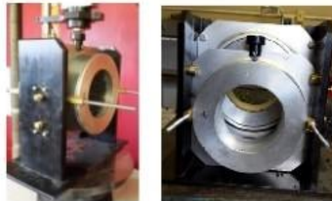
Figura 2 Dispositivo de ensayo de corte creado para el proyecto
