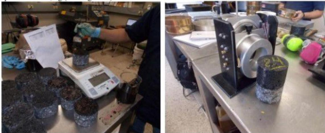
Figura 1: a. Aplicación de emulsión asfáltica en especímenes y b. Especimen terminado y dispositivo para fallar especímenes
