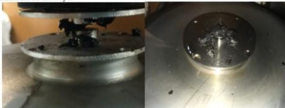
Figura 7 Muestra de asfalto fracturada luego del ensayo de Fatiga a Esfuerzo Controlado
