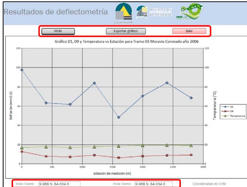
Figura 18. Gráfico D1, D9 y Temperatura contra estación de medición de medición para año en tramo escogido
