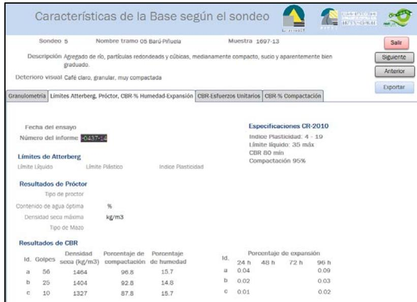
Figura 7. Resultados para la base (límites de Atterberg, Próctor, CBR Humedad-Expansión)
