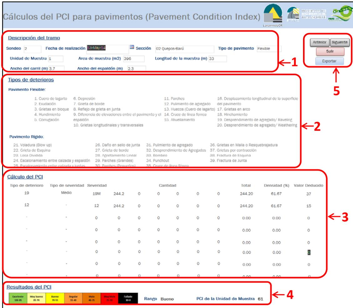
Figura 23. Detalles de muestreo de parámetro PCI para tramo escogido
