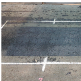
Gráfico deformación de la superficie 004AC3 1.120.000 repeticiones
