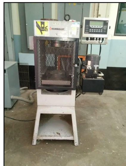
Fotografía 2. Máquina de ensayos utilizada para el alcance de 1 000 kN.
