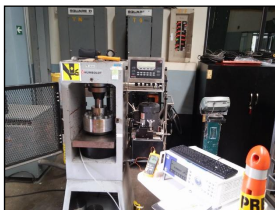
Fotografía 4. Patrón de fuerza de 1 000 kN instalado en la máquina de ensayos.
