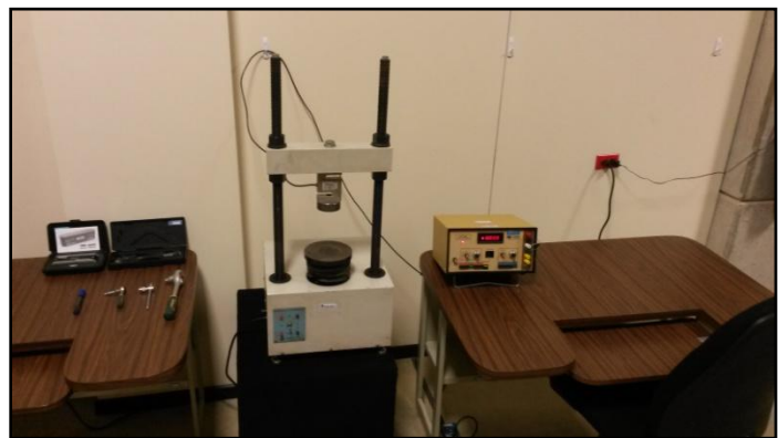
Fotografía 1. Máquina de ensayos utilizada para el alcance de 50 kN.
