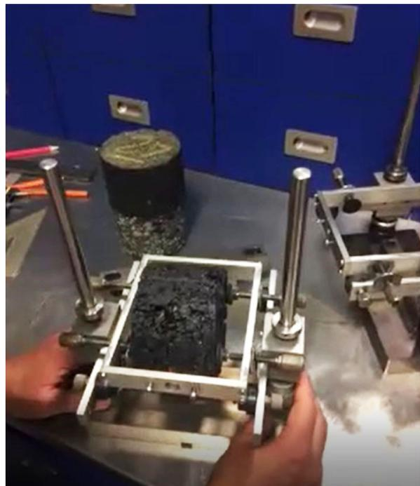
Figura 1. Colocación del espécimen en la muela de carga.
