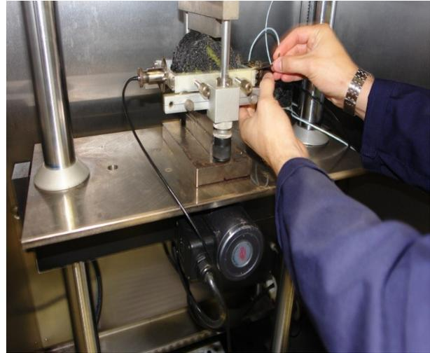
**Figura 2. Instalación del espécimen en el equipo para realizar el ensayo.**
