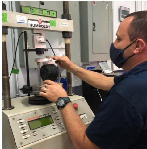
**Figura 3. Colocación de espécimen en equipo de ensayo.**
