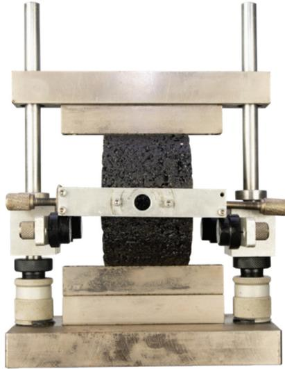
**Figura 2. Equipo para fallar los especímenes secos y acondicionados.**
