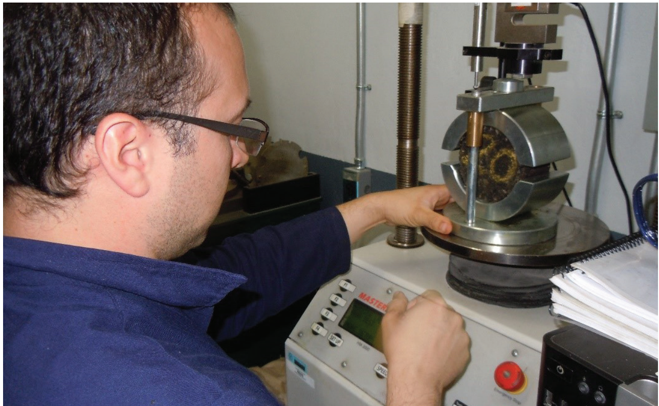
Figura 1. Colocación del equipo para aplicación de carga y medición del flujo.
