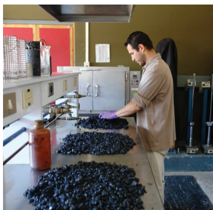
Figura 1. Separación de la mezcla asfáltica suelta.
