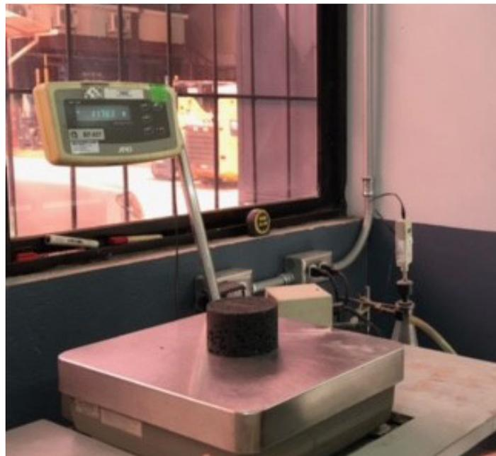
**Figura 1. Medición de la masa seca del espécimen.**
