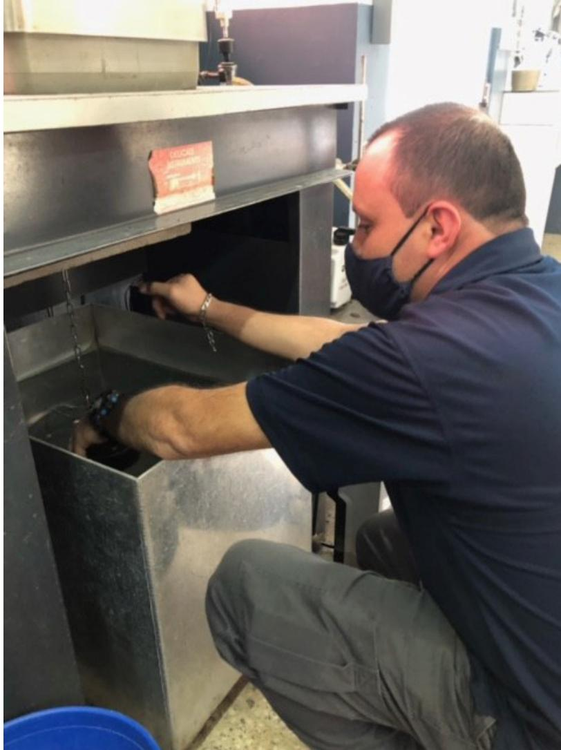
**Figura 2. Medición de la masa sumergida.**
