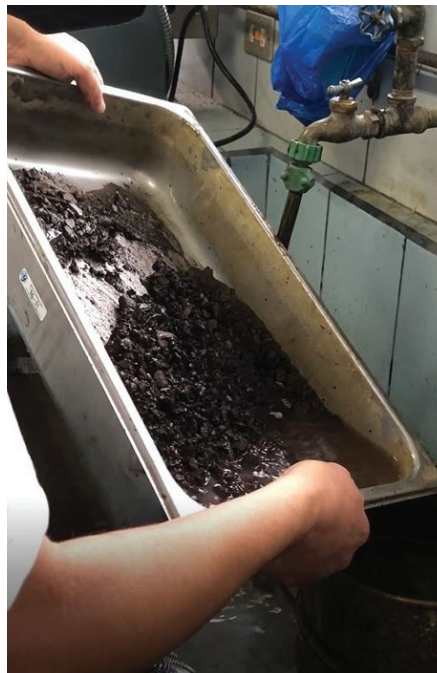
Figura 2. Decantación de agua con partículas final del agregado.
