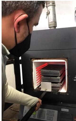
**Figura 2. Colocación de especímenes en el horno de ignición.**
