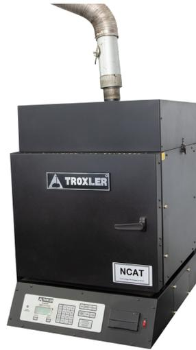
**Figura1. Horno de ignición empleado para la realización del ensayo.**
