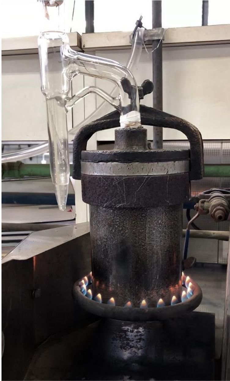
Figura 2. Aplicación de calor para iniciar proceso de reflujo.
