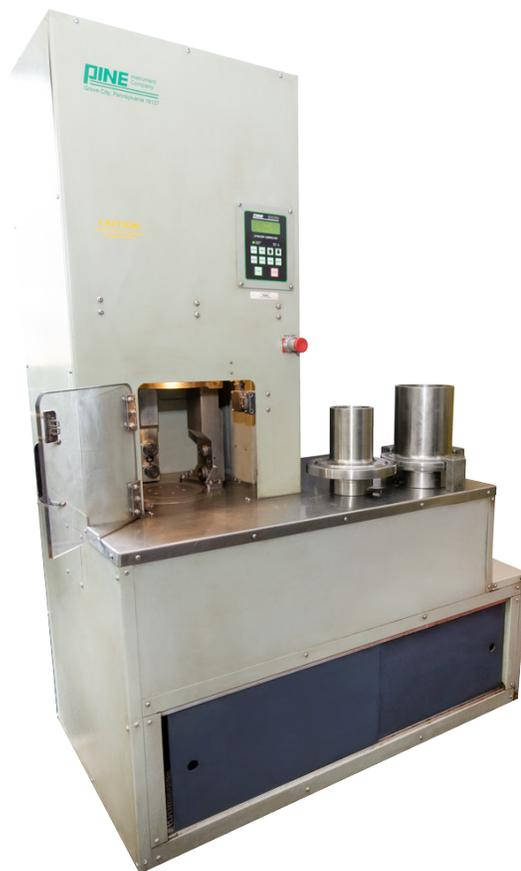
Figura 1. Equipo para realizar la compactación.
