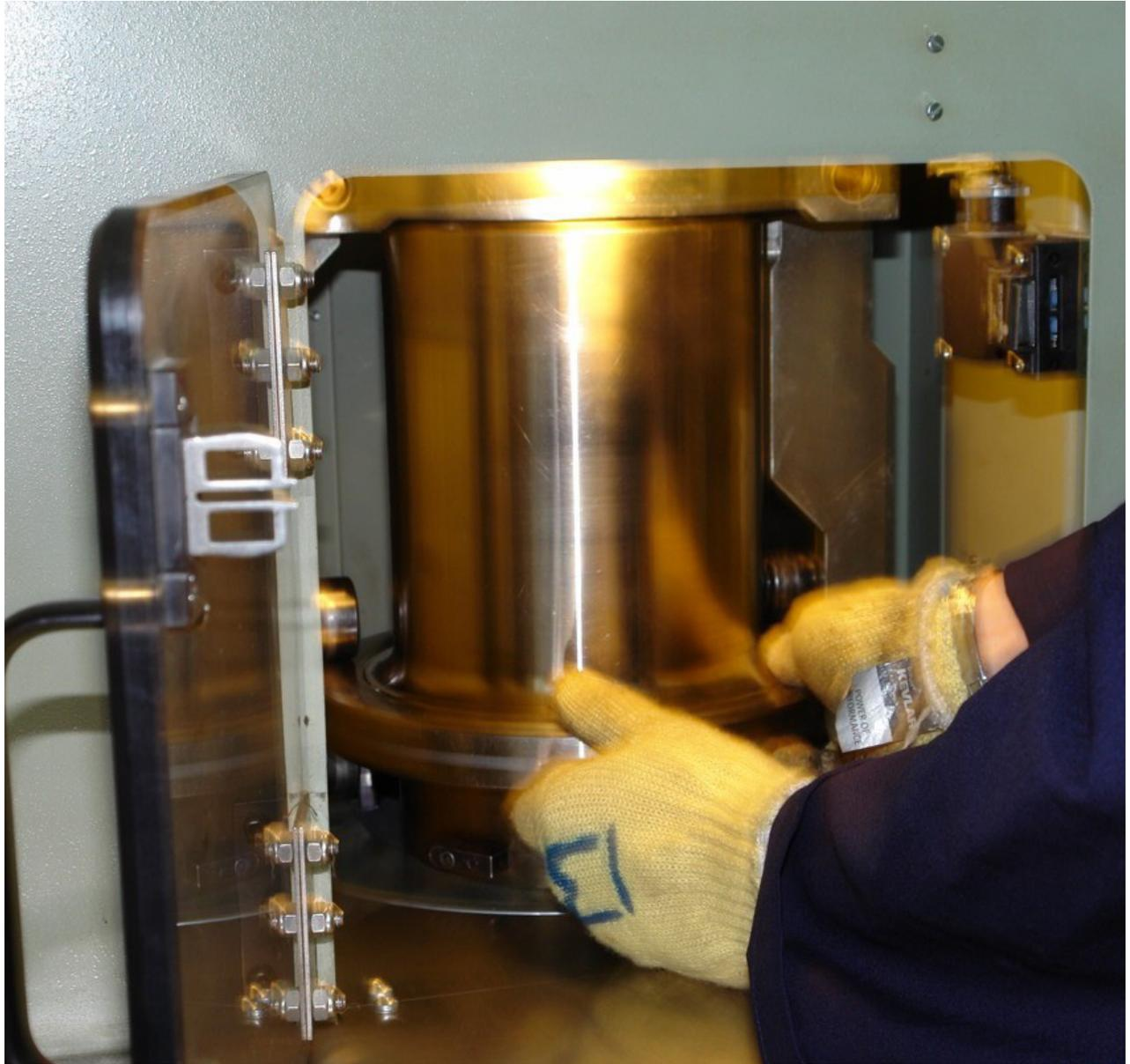
**Figura 2. Colocación del espécimen en el compactador giratorio SuperPave.**
