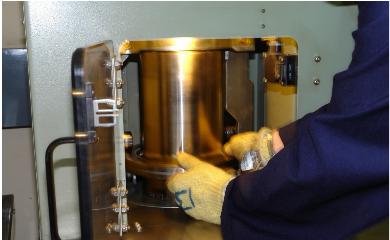
Figura 1. Colocación de espécimen de ensayo.
