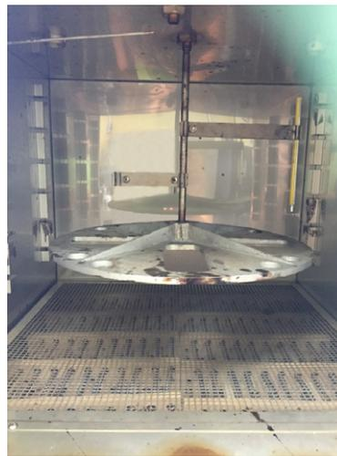
**Figura 1. Equipo para determinación del efecto de la ventilación y el calentamiento: horno de película delgada (TFO).**
