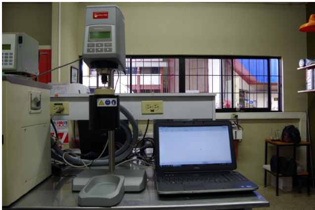
Figura 1. Equipo para determinación de viscosidad dinámica: viscosímetro rotacional.
