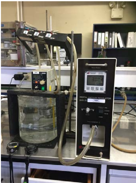
Figura 1. Equipo para determinación de viscosidad absoluta: sistema de vacío, baño de agua, viscosímetros para vacío y termómetros.
