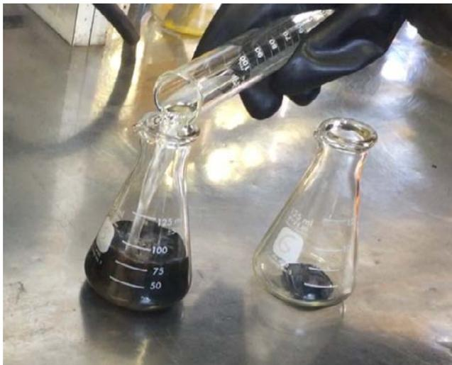
**Figura 1. Disolución de espécimen de ensayo en tricloroetileno, junto con espécimen sin diluir.**
