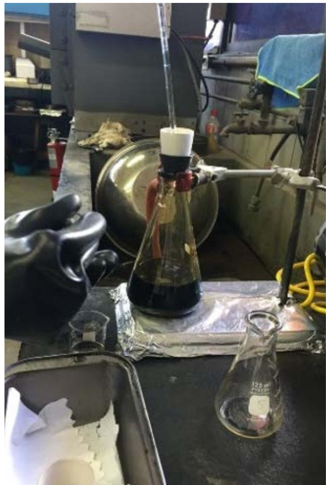
**Figura 2. Filtración al vacío.**
