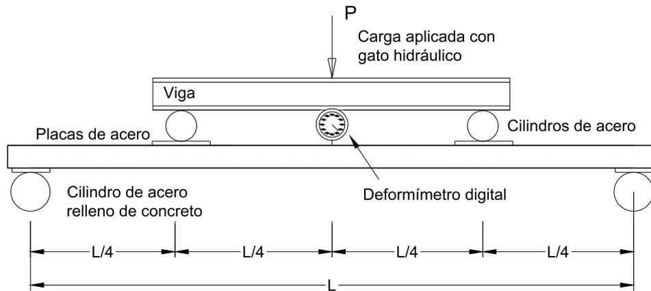
Esquema del montaje para el ensayo
