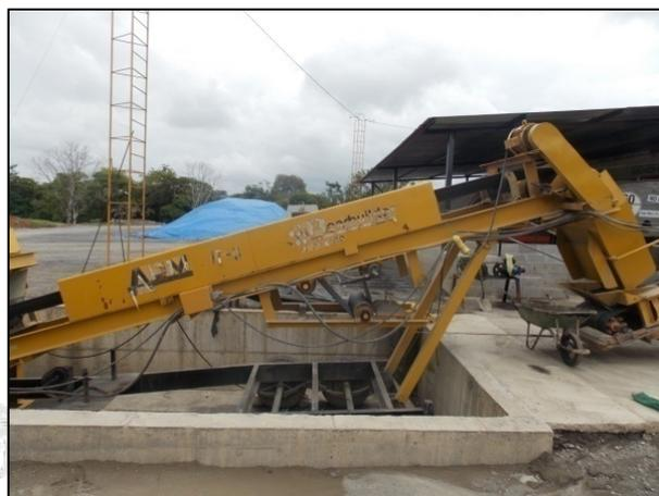
**Fotografía 5.** Banda transportadora de agregados combinados
