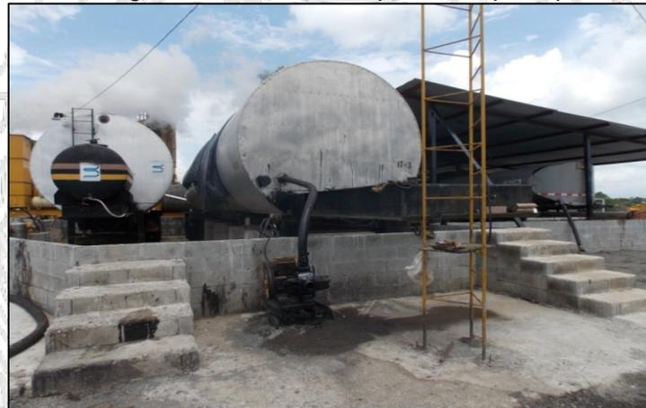
**Fotografía 2.** Tanques de asfalto
