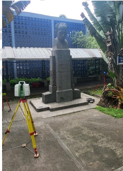
Figura 1. Escáner láser Leica DC-10 utilizado para el levantamiento del busto de Clodomiro Picado. Al fondo a la derecha se puede observar unos de los objetivos de control.
