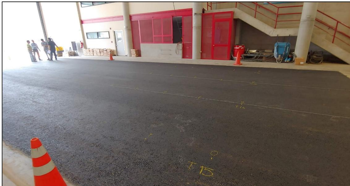
**Figura 42.** Demarcación del tramo experimental para el ensayo de FWD.
