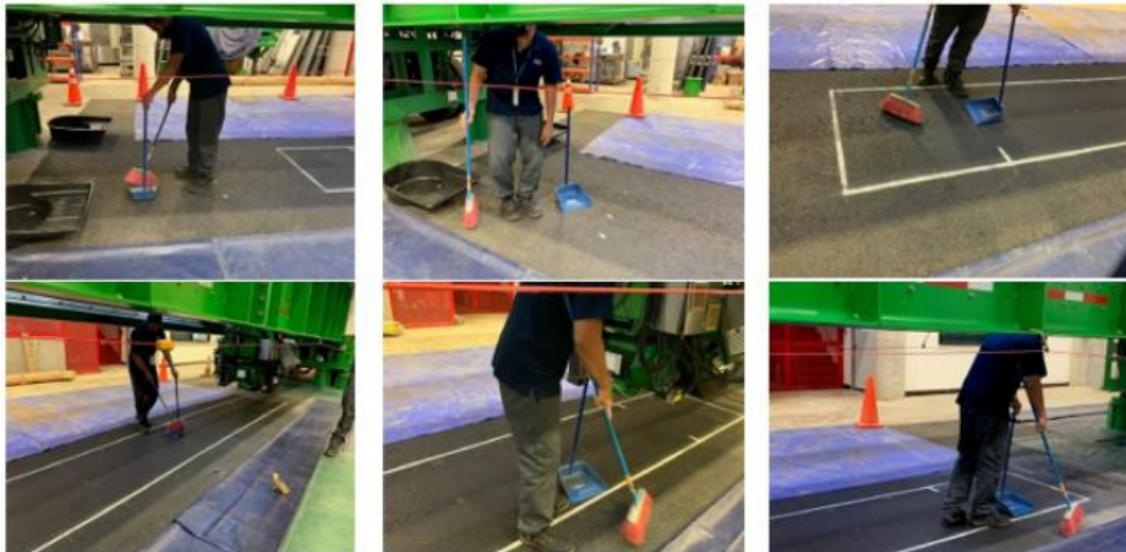
**Figura A3.5.** Secuencia de barrido de la pista para la recolección del material residual.
