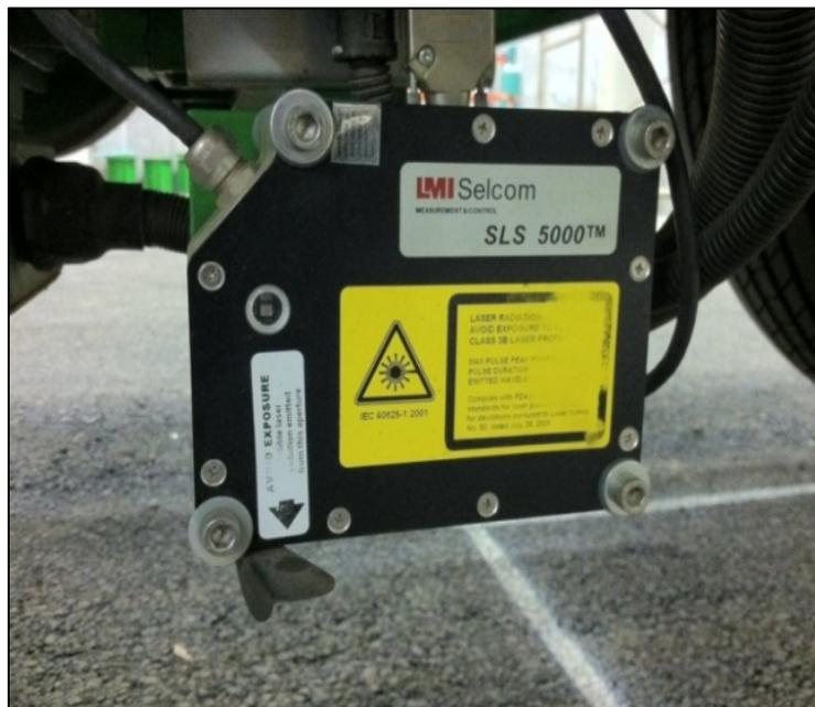
**Figura 4.** Perfilómetro láser.
