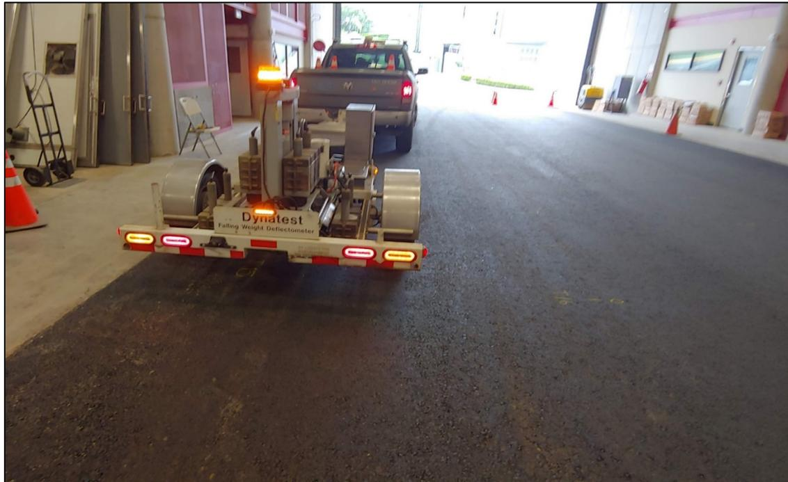
**Figura 43.** Ejecución del ensayo de FWD.
