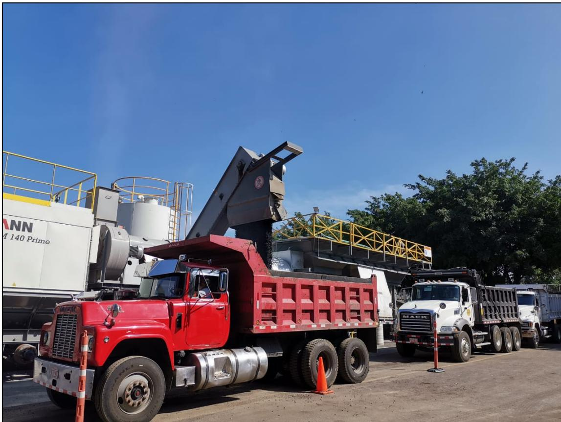
**Figura 29.** Salida de la mezcla asfáltica de la planta mezcladora.
