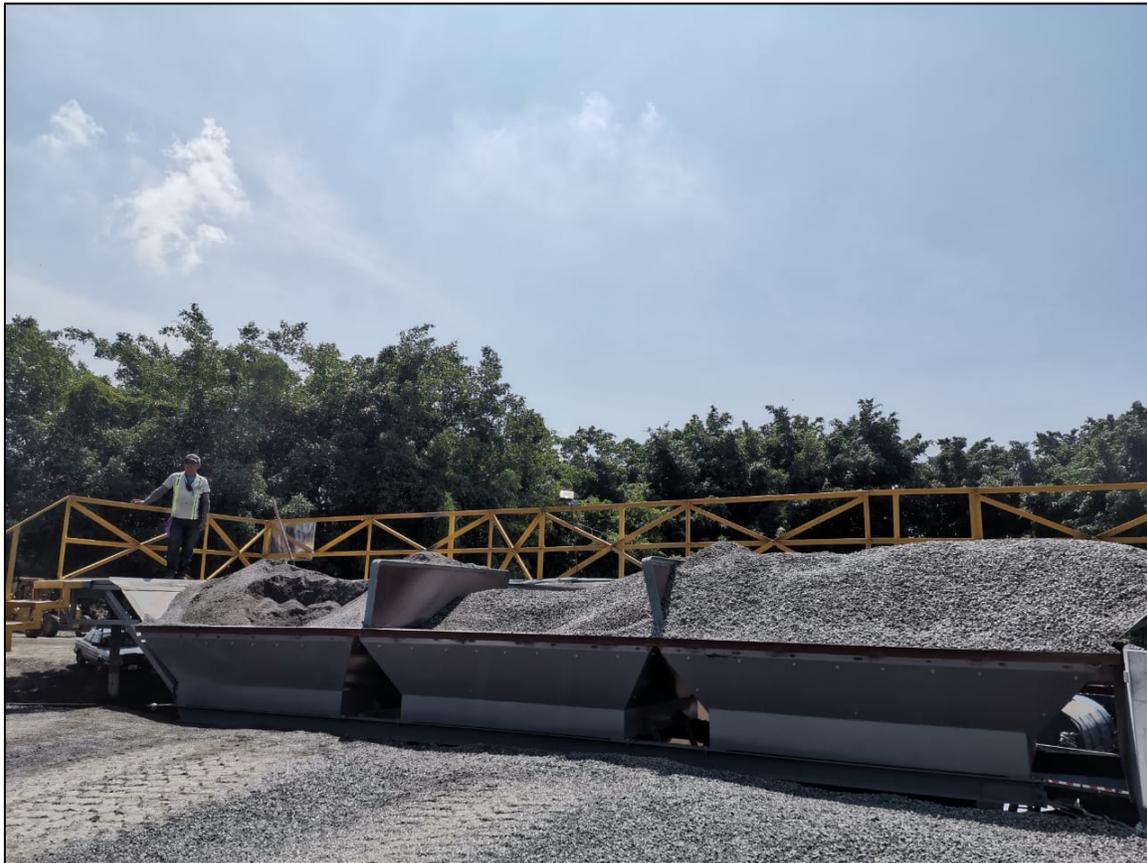
**Figura 25.** Tolvas de la planta de producción.
