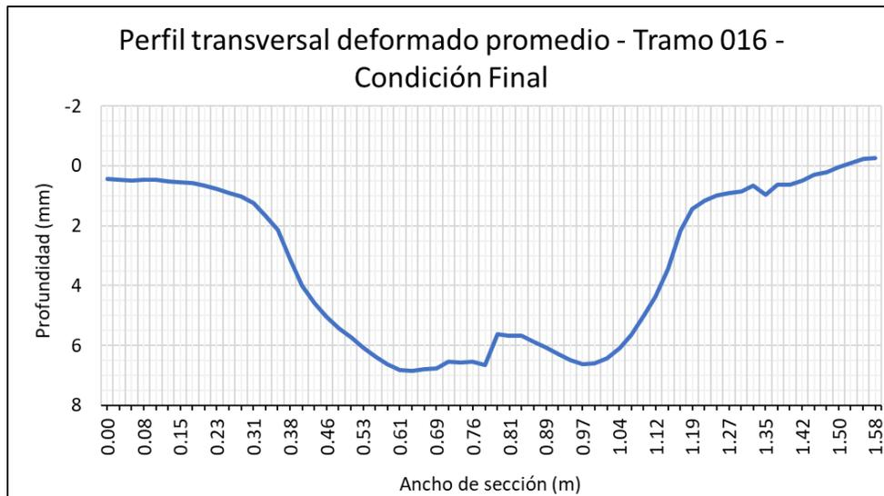
**Figura 75.** Perfil transversal promedio deformado para el tramo 016 final.
