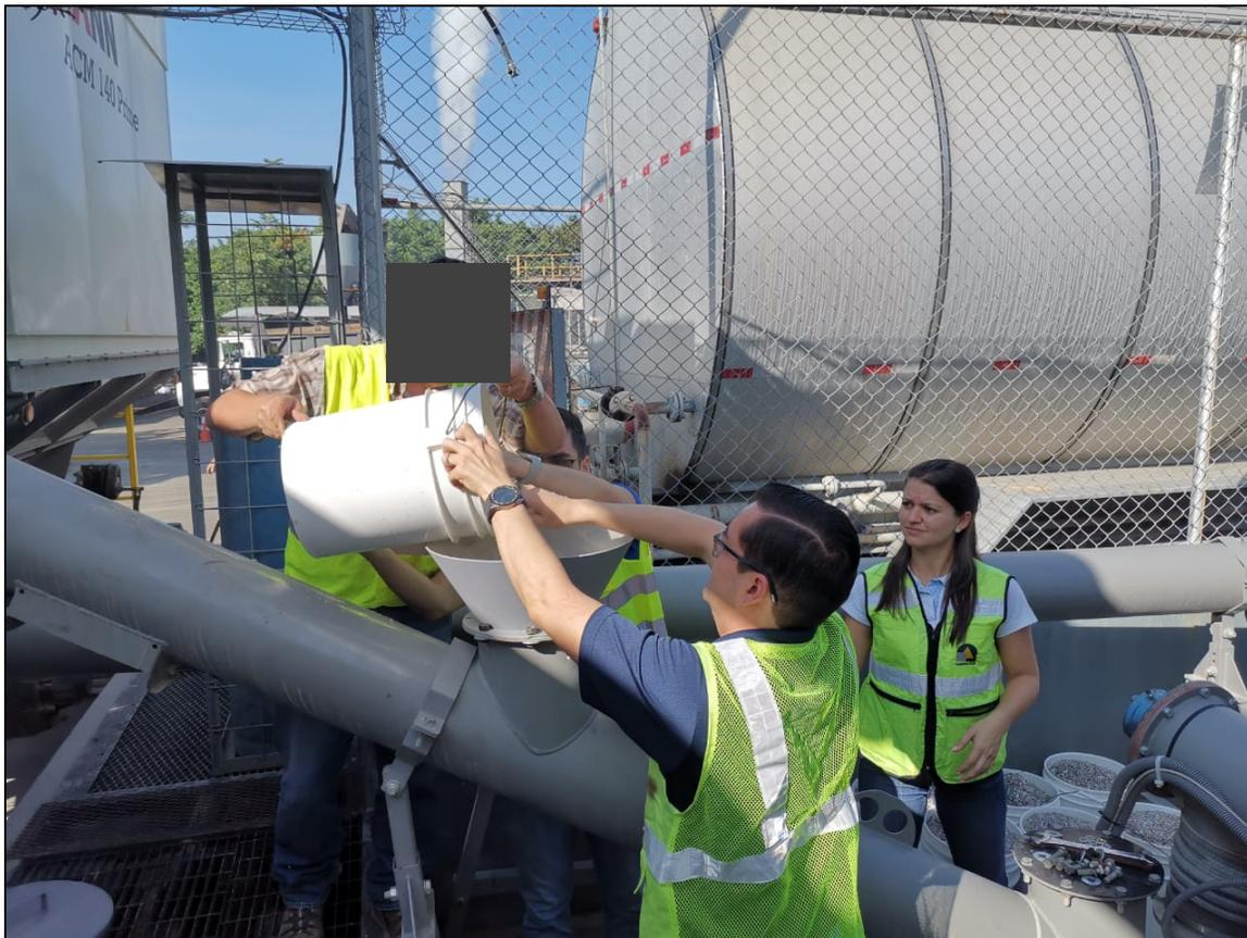
**Figura 27.** Dosificación manual del material de desecho.
