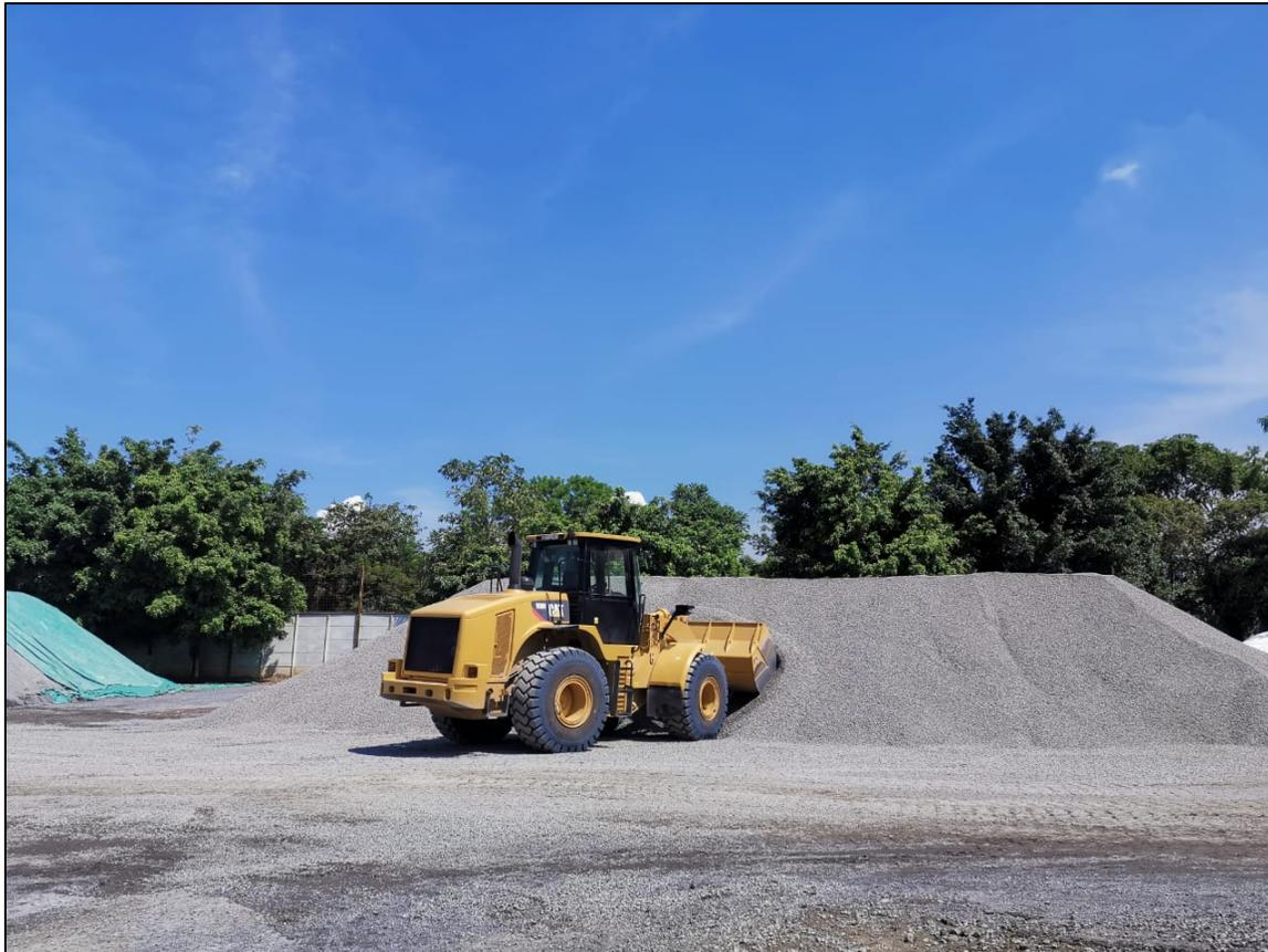
**Figura 23.** Cargadora recolectando los agregados de para la producción de mezcla.
