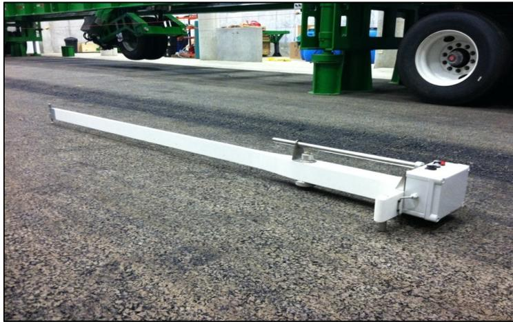
**Figura 7.** Deflectómetro de superficie del pavimento.
