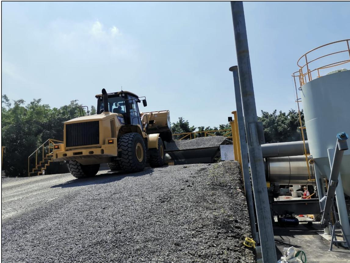
**Figura 24.** Depósito de los agregados en las tolvas que alimentan la planta.
