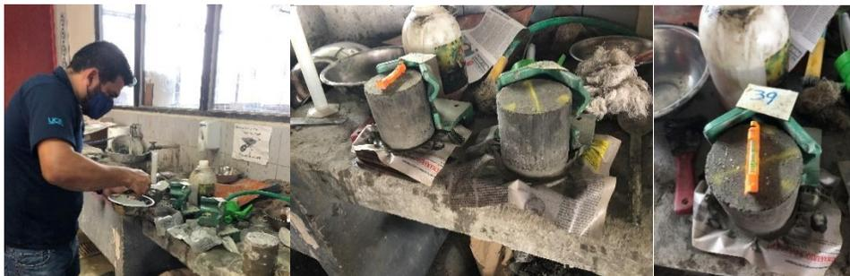
**Figura 2** Mezcla y colocación de pasta para el coronamiento
